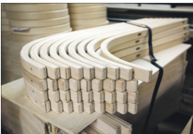
Die Teile bestehen aus mehreren geklebten Holzschichten.
